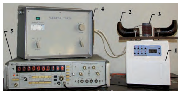
Рис. 1. Механомагнітний реактор: 1 — механохімічний реактор (мікробромлін); 2 — постійні магніти; 3 — індуктор; 4 — ВЧ-генератор; 5 — частотомір
