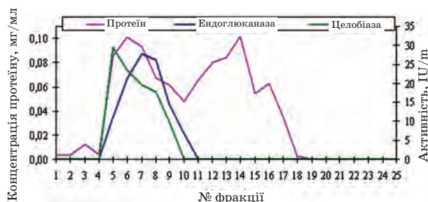
Рис. 2. Хроматограма препарату целюлаз штаму Д-1 Irpex lacteus під час пропускання його через колонку із Sephadex G-75: розмір колонки 10×300 мм, швидкість потоку — 20 мл/год, об'єм фракції — 2 мл
