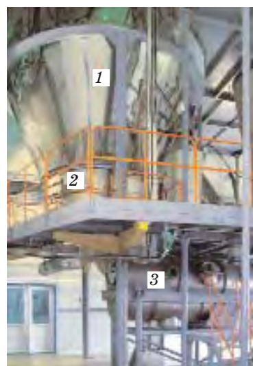
Рис. 8. Тристадійна розпилювальна сушарка (1) з флюїдним днищем (2) і віброфлюїдайзером (3) А1-ОР2С
