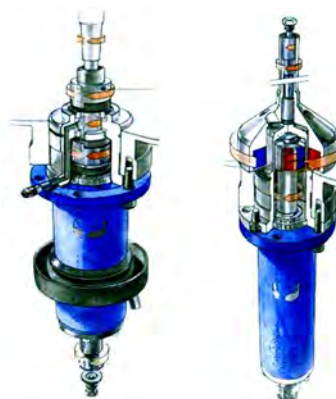
Рис. 2. Способи ущільнення вала перемішувального пристрою пілотного ферментера Laboratory Pilot Fermenter LP351
