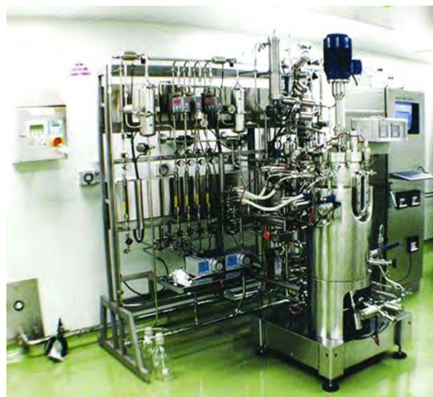
Рис. 4. Багатоцільова пілотна установка фірми Bioengineering AG для GMP-ферментації в чистій кімнаті (варіант 1)
