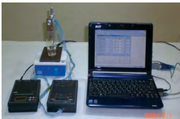
Кондуктометричний біосенсор на основі ацетилхолінестерази
