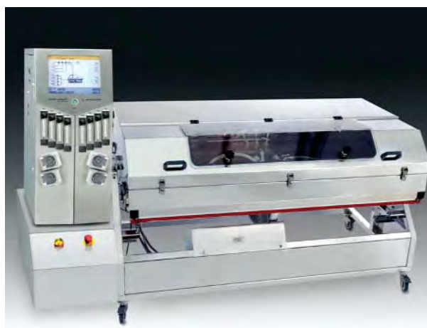
Рис. 13. Варіант ферментера Biostat Cultibag RM для роботи з клітинами тварин, рослин і комах
