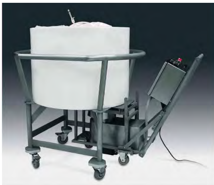
1 — магнітний левітатор; 2 — одноразовий пластиковий імпелер (шар мішка не показано)
