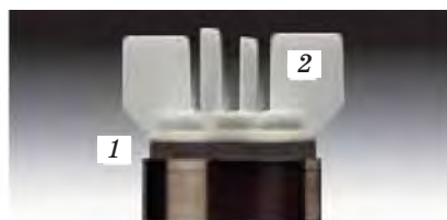
1 — магнітний левітатор; 2 — одноразовий пластиковий імпелер (шар мішка не показано)
