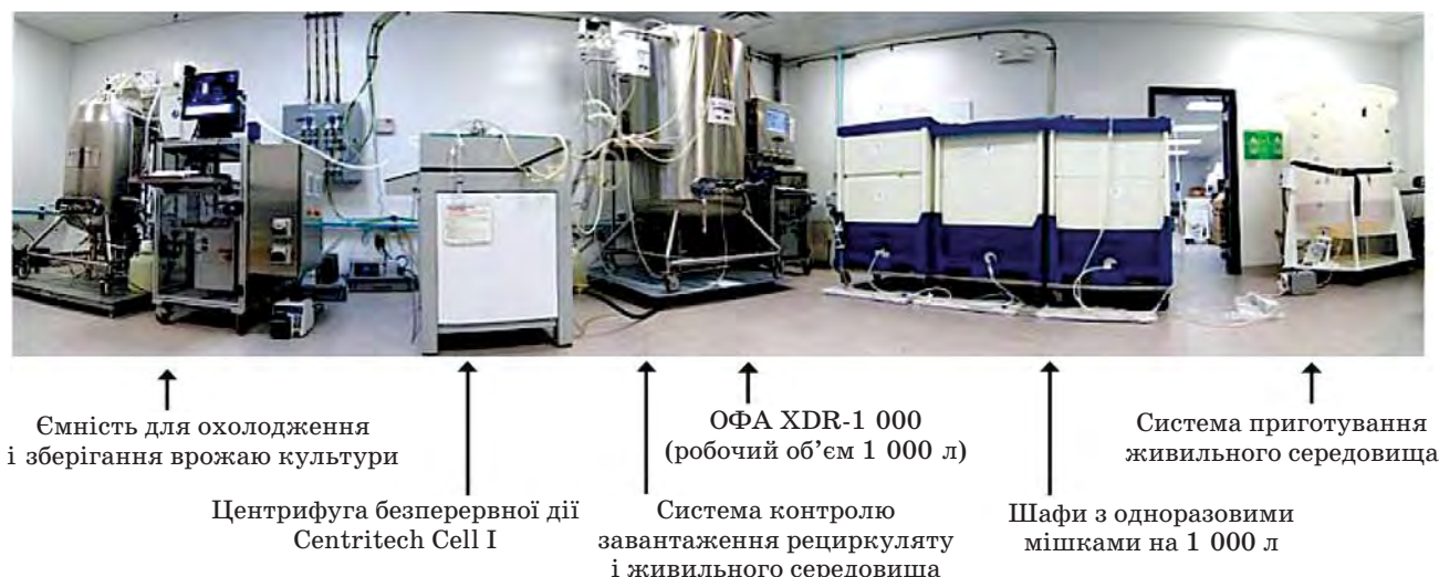
Рис. 28. Обладнання компанії Xcellerex для проведення безперервного процесу ферментації з використанням ОФА
