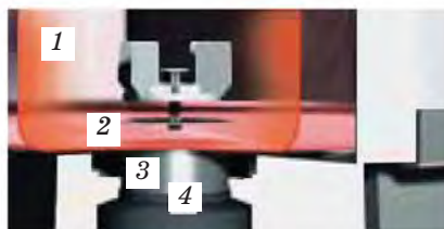
1 — одноразовий мішок; 2 — пластина, що пов'язує імпелер і магнітний левітатор, з вирівнювальним штифтом 3 — тепловий розділювач 4 — надпровідник
