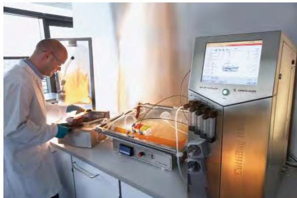
Рис. 14. Пілотний ферментер Biostat Cultibag RM 20/50 (20 л)
