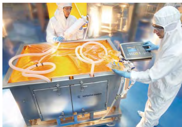
Рис. 18. Одноразовий мішок Flexel 3D
