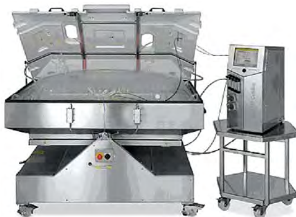
Рис. 15. Пілотний ферментер Biostat Cultibag RM 20/50 (50 л)
