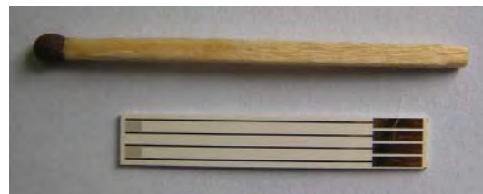
Рис. 1. Зовнішній вигляд кондуктометричних планарних гребінчастих перетворювачів
