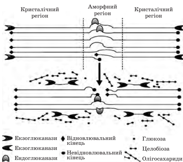
Рис. 5. Схема гідролізу целюлози за допомогою целюлаз [44]
